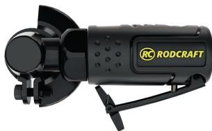
Pneumatic angle grinder RC 7103 Mini 50-59 mm 18000 min<sup>-1</sup> 60 l/min
